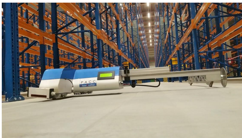
FloorProfiler; meetrobot welke de gecertificeerde vlakheidsmetingen verricht.
